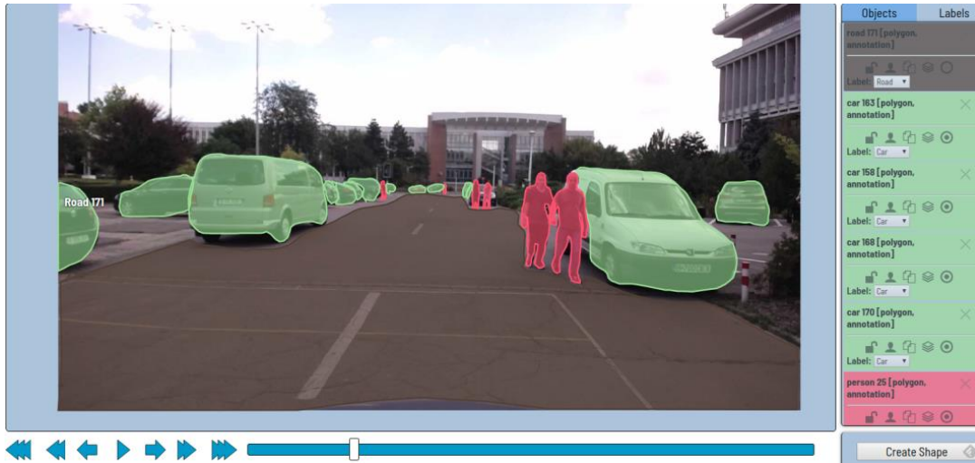
Figura 3.1. Exemplu din utilitarul CVAT de adnotare semantica a celor 3 clase urmarite a fi clasificate in noua iteratie a setului de date UPB: sosea navigabila (maro deschis), pietoni (rosu ), masini (verde)
