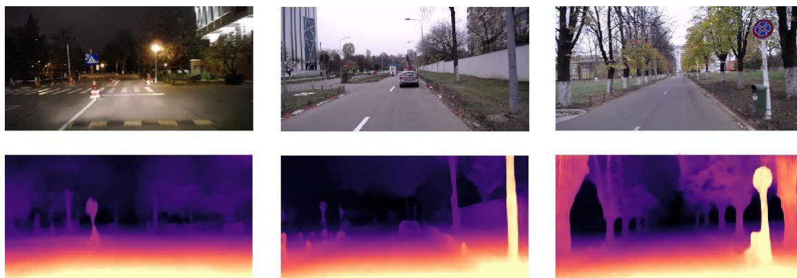
► Figura 4: Rezultate ale estimării adancimii din input monocular. Imagini din setul de date UPB. Randul de sus prezintă imaginea RGB. Randul de jos prezintă imaginea de adancime (disparity map) aferentă.
