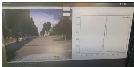
Figura 2.4. Asistare șofer conducere semi-autonomă. Prima imagine - automobilul menține banda în mod autonom, șoferul nu controlează volanul (șoferul este în auto pentru siguranță și are un comutator de urgență pentru comutarea în mod controlat de șofer). A 2-a și a 3-a imagine – pe ecran apare în stânga ceea ce vede camera video în timp real iar în dreapta estimarea direcției de mers (cu albastru) față de direcția dorită (cu roșu) pe baza modului antrenat cu rețea neurală în prealabil în simulator și utilizând setul de date UPB augmentat.
