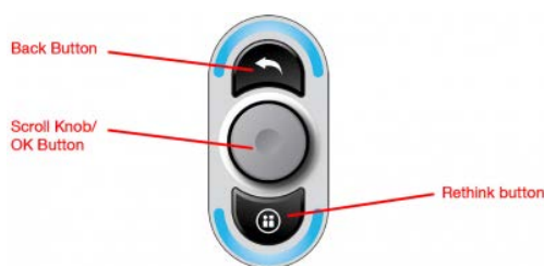
Fig 6. Elemente ale unui buton manșetă pentru robotul Baxter.
