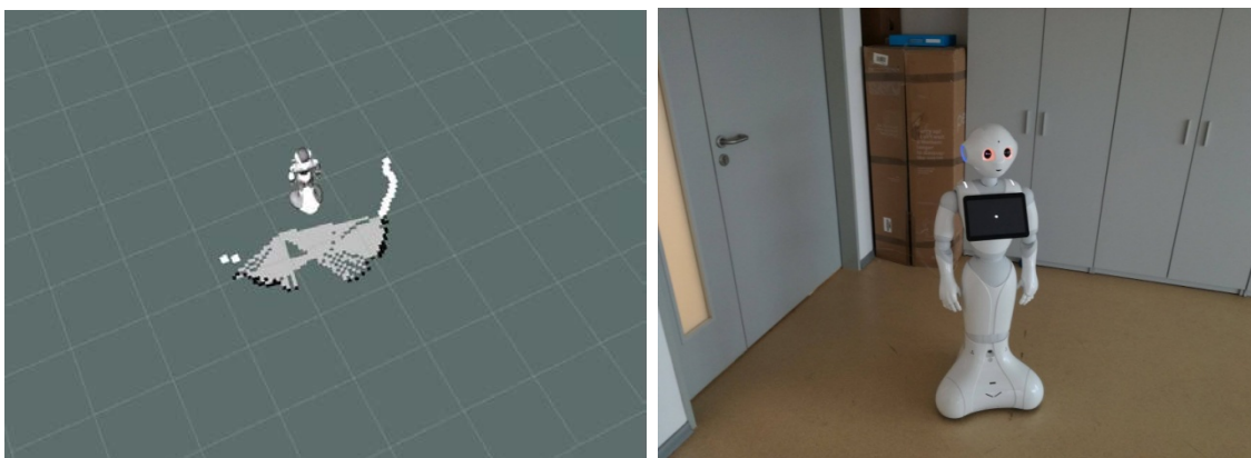
Fig. 4. Pachetul ROS gmapping pe Pepper. Harta scoasă de pachet, vizualizată în rviz, este afișată în partea stângă, corespunzând unui mediu real de laborator vizibil în partea dreaptă a figurii.
